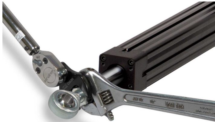
Abbildung 4.3: Bei RSA halten Sie die Schubstange mit einem Schraubenschlüssel an den Abflachungen am Ende der Schubstange fest, wenn Sie Zubehör, Gestänge oder Last am Antrieb befestigen.
